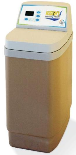
Bei der Enthärtungsanlage KW Midi Soft handelt es sich um eine mengen- und zeitabhängig gesteuerte Einzelanlage in Kompaktbauweise. Die Anlage liefert nach dem Prinzip des Ionentausches mit integrierter frei einstellbarer Verschneidung weiches Wasser vorzugsweise im Härtebereich 1. Die Anlage wird mit Sparbesatzung oder Vollbesatzung des Ionentauscherharzes während der Regeneration betrieben. Der Wasserzähler ist integriert. Die Anlage ist gemäß DIN 1988 für bis zu 10-Familienhäuser einsetzbar.
